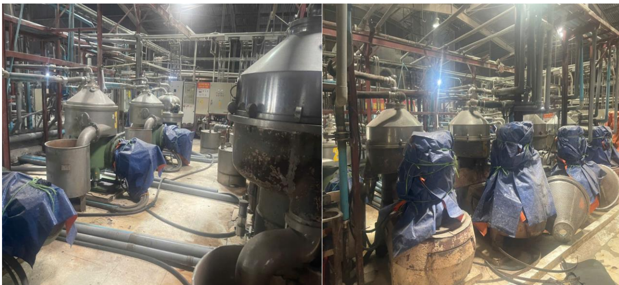
Hình 8: Công đoạn lọc tinh bột
