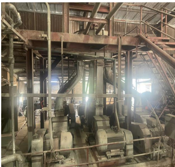
Hình 7: Công đoạn cô đặc tinh bột
