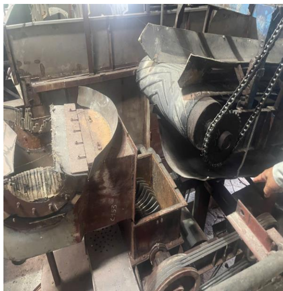
Hình 6: Công đoạn tách tinh bột
