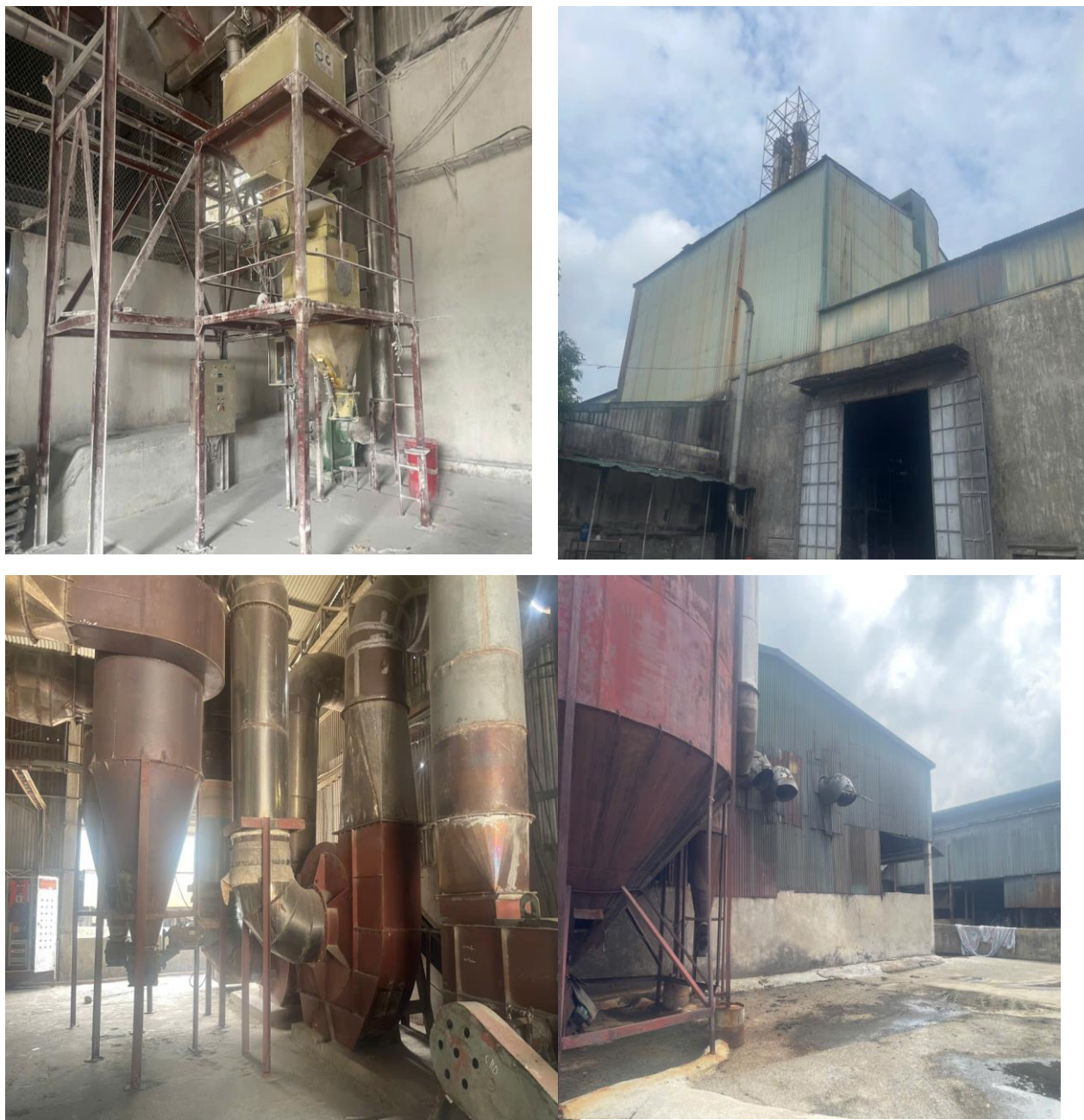
Hình 33. Một số hình ảnh về Cyclon giảm thiểu bụi tại các dây chuyền
