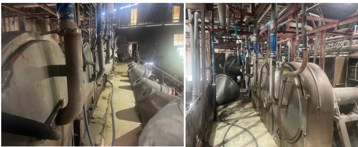
Hình 9: Công đoạn lọc xơ
