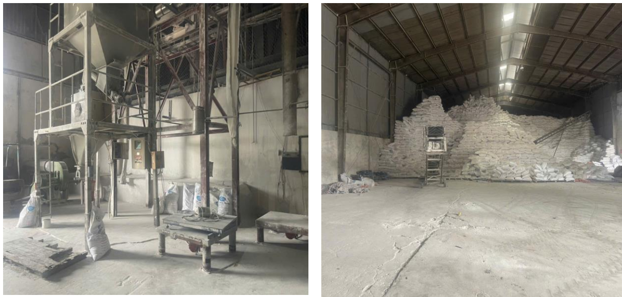
Hình 12: Công đoạn đóng bao
